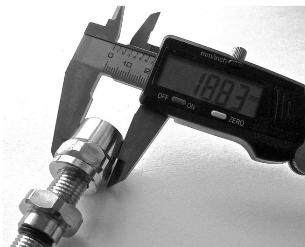
Ancien modèle de raccord (Flexible AP150) -18,8 mm de diamètre
