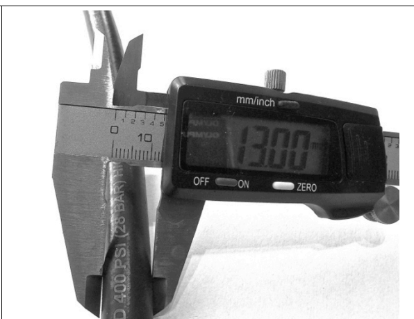
Nouveau flexible MP standard de 13 mm de diamètre externe
