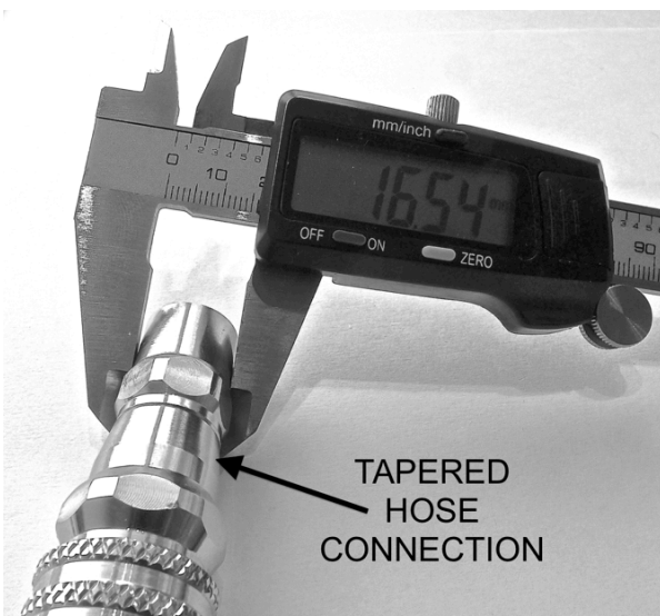
Nouveau modèle de connecteur rapide (Flexible EV50) – Gaine conique 16,54 mm de diamètre
